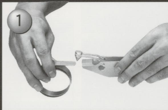
1 締め工具の口元までバンドの末端を十分に差込んで下さい。
