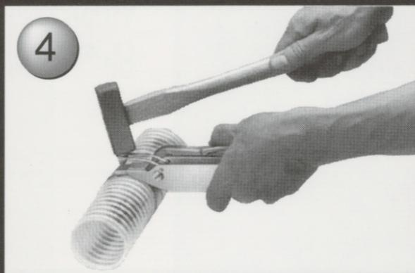
4 締め終わったら、ハンドルをゆるめないよう押えたまま固い台の上に置き、ポンチをキャップに当てハンマーで2～3度強く打って下さい。
