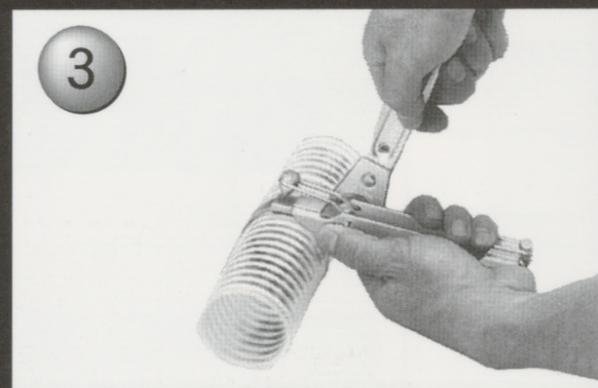
3 割ピンの六角頭にラジェットハンドルを矢印を手前にしてはめ、十分にバンドが締められるまで前後に動かして下さい。注意・・・作業中、割ピンが外れないように一方の手の親指と人さし指で押さえると便利です。
