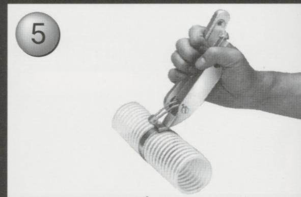
5 締め付をゆるめずフレームを折返すように上げると、簡単にバンドが切れます。バンドの残った部分は、割ピンを自由にしてやり、差込んだ時と反対に引抜くとはずれます。
