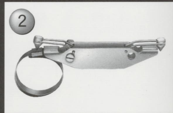
2 割ピンをフレームの穴に差込み、バンドの末端をピンの割口にはさみます。
